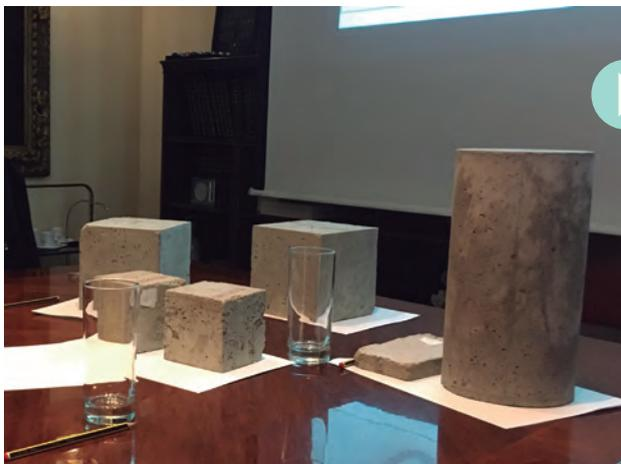
Primeras probetas de hormigón con sensores RFID embebidos.
