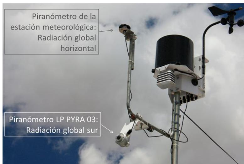
Figura 35. Orientación de los piranómetros para el registro de la radiación global horizontal y radiación global sur
