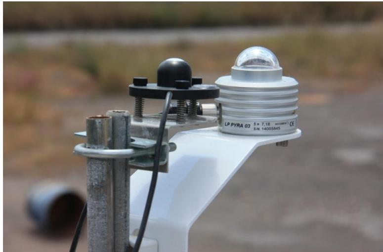
figura 13 Piranómetro LP PYRA 03 (color metálico) montado junto al piranómetro de la estación meteorológica (color negro)
