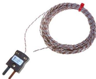
Figura 12 Termopares tipo T
