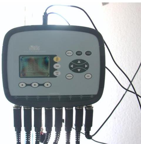
*Figura 6. Datalogger para la lectura de temperaturas interiores (sensores PT100)*
