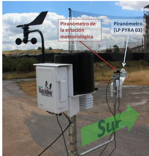
Figura 31 Posición de los piranómetros
