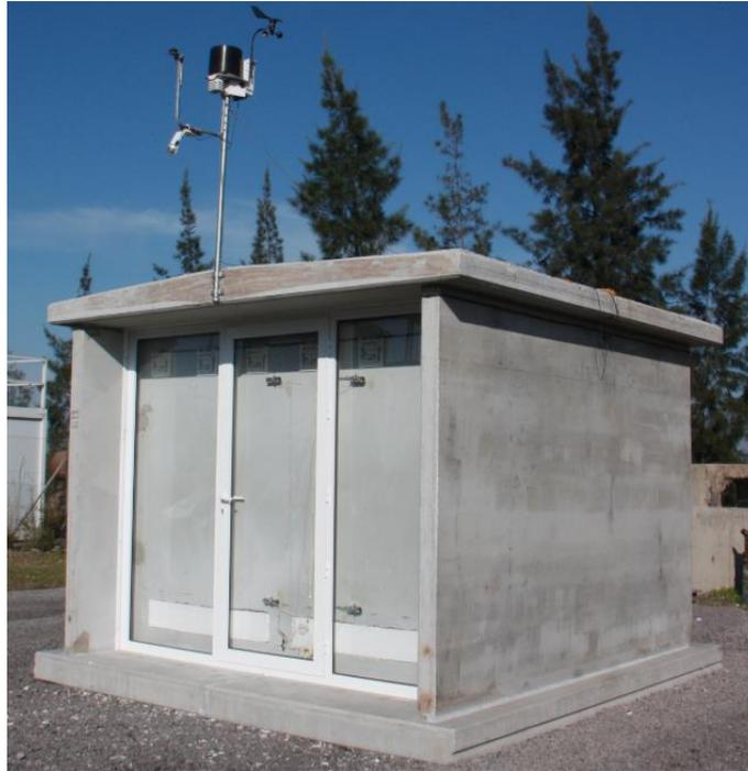
figura 38 Caseta con la fachada activa ventilada configurada en modo invierno.
