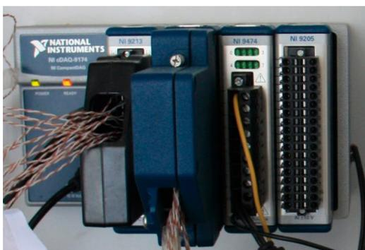
Figura 3 Módulos para la lectura de sensores y actuación sobre los ventiladores
