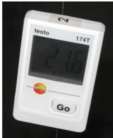
*Figura 9 Datalogger para la medición de temperatura de aire interior*
