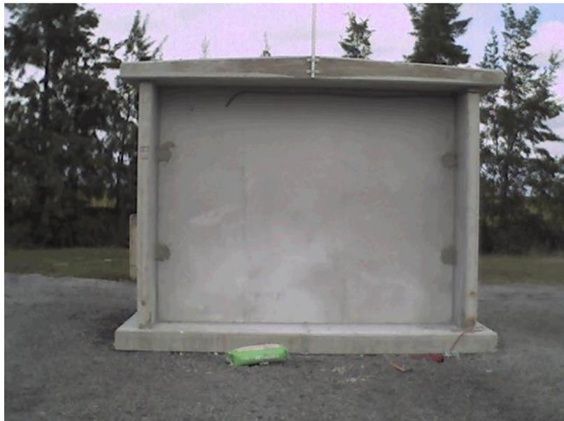
figura 68 Sombreamiento de la radiación difusa. En la foto se puede apreciar, cómo, los laterales y el voladizo producen una ligera sombra sobre la fachada
