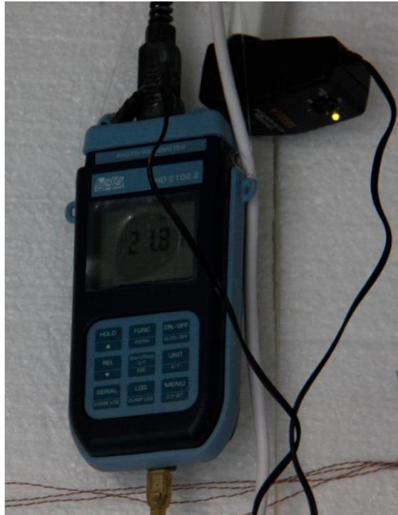
figura 14 Datalogger HD-2102 para el registra de la radiación solar global
