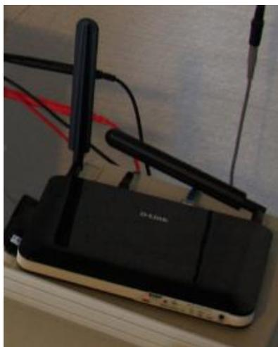
Figura 4. Router 3G/4G, para la monitorización remota de la caseta
