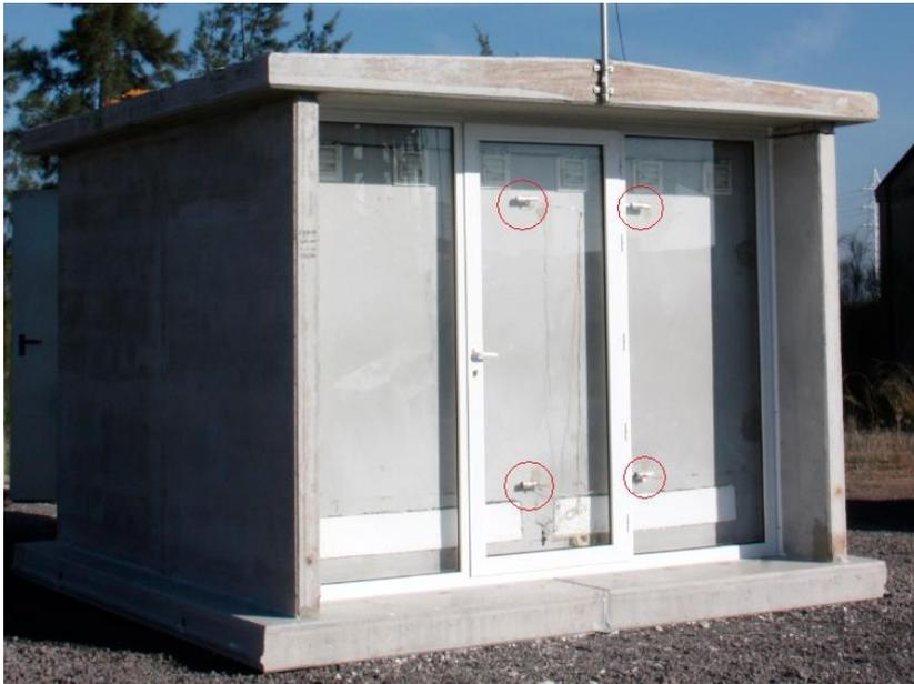
figura 59 Vista del elemnto sinhor configurado en modo invierno, Se pueden ver los puntos de media de temperatura
