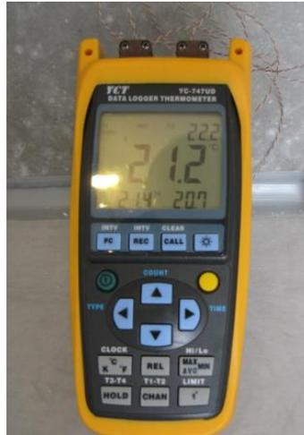
*Figura 8 Datalogger para la lectura de temperaturas superficiales (sensores: termopares tipo T)*
