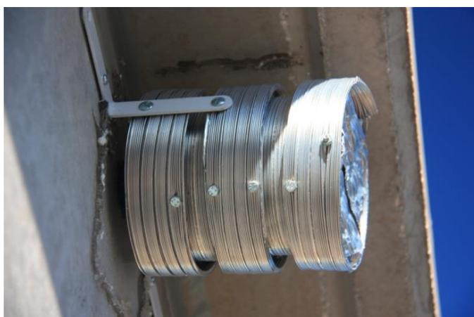
Figura 16. Carcasa para la de protección para el sensor de temperatura exterior.
