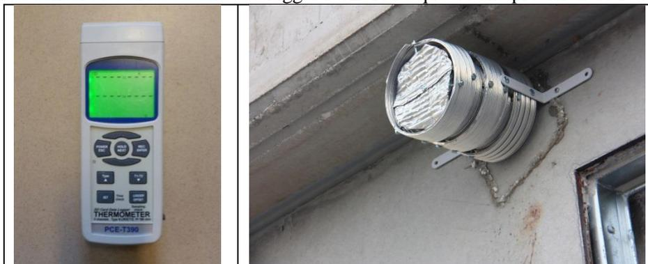
figura 11 Datalogger PCE-T390 y vista del contenedor de protección de la PT100 para la medición de la temperatura exterior.
