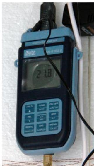
*Figura 7. Datalogger para la lectura de la radiación solar*
