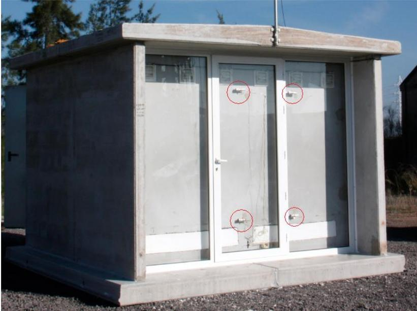
Figura 43. Vista del elemento sinhor configurado en modo invierno, Se pueden ver los puntos de media de temperatura
