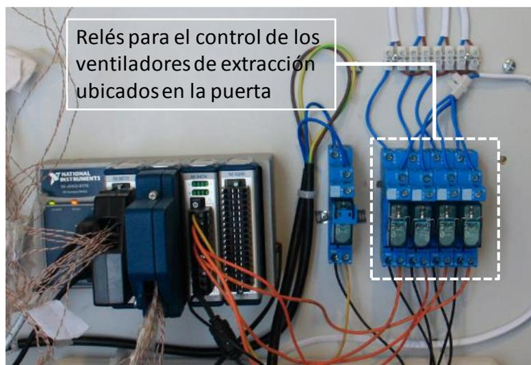
Figura 38. Modificaciones realizadas al sistema de control
