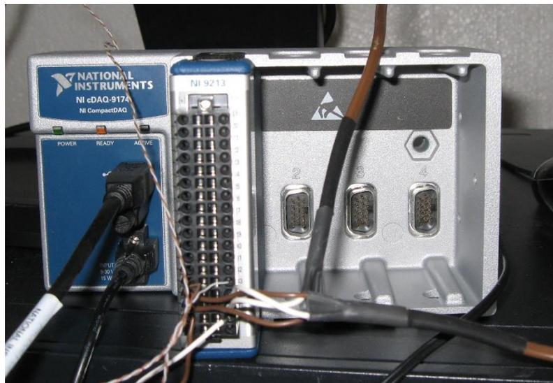
figura 7. Sistema de adquisición de datos CompaqDAQ, con un módulo para la lectura de 16 termopares.
