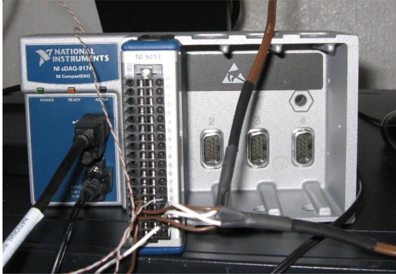
Figura 25. Sistema de adquisición de datos CompaqDAQ, con un módulo para la lectura de 16 termopares.
