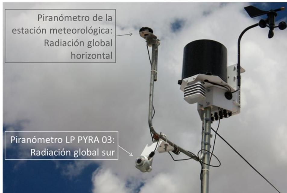
figura 36. Orientación de los piranómetros para el registro de la radiación global horizontal y radiación global sur
