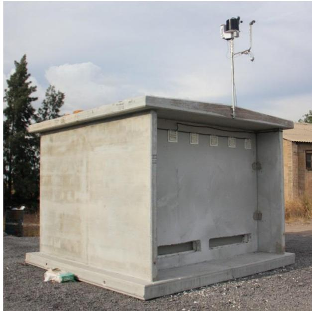
*figura 15 Caseta con la fachada activa ventilada configurada en modo verano.*
