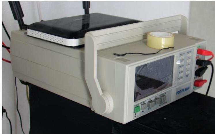
Figura 36. Analizador de potencia PCE PA 6000
