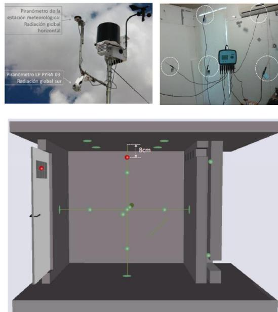
*Figura 4: Sensores y esquema de monitorización del prototipo*
